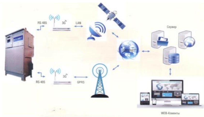
Рисунок 2. Элементы АСУ «Интеллектуальное месторождение» система Novomet-Track
